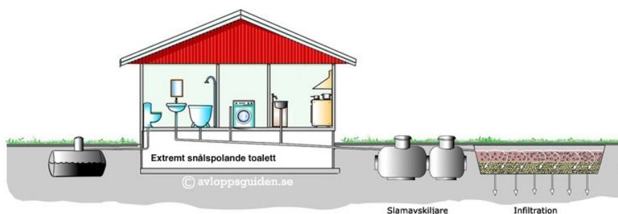
Figur 8. Principskiss för sluten tank för WC i kombination med infiltration för BDT-vatten. Källa: Avloppsguiden
