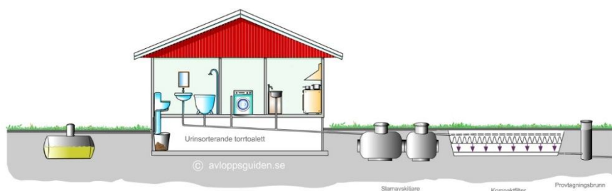
Figur 5. Ett exempel på hur en anordning med kompaktfilter kan se ut. Källa: Avloppsguiden
